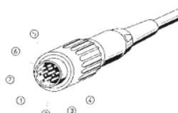
Træk fingerkontaktkappen af, hvis føleren eller varmeelementet er afbrudt, fjern tre flangeskruer, og træk varmeelementet ud fortil.
