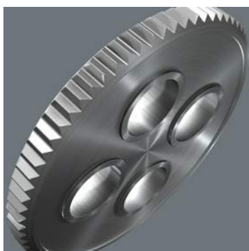
Zyklop Metal Switch Jemné ozubení přepínací ráčny se 72 zuby má úhel zpětného otočení pouze 5°. Malý zdvih umožňuje rychlou a přesnou práci ve všech montážních polohách.
